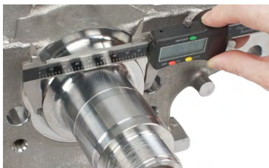
Foto 2: W celu wybrania właściwego pierścienia, należy dokonać pomiaru posadzenia czopu
