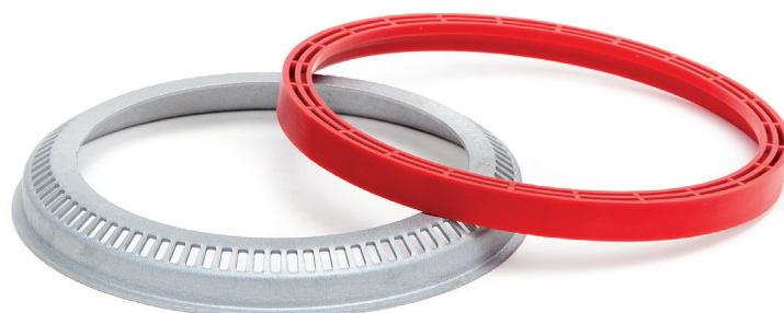
Anillo sensor ABS 434 0497 10 con herramienta especial para montar a presión
