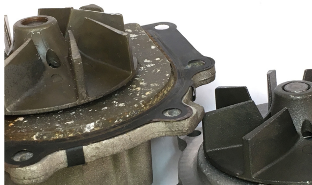
Fig. 1: Rotor desplazado con huellas debido al roce (izquierda), asiento correcto del rotor (derecha)
