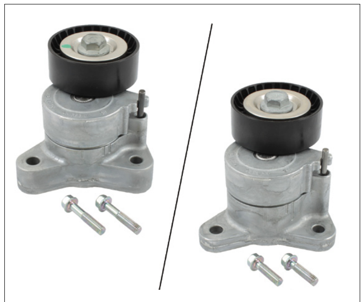
Imagen 1: Brazo tensor 534 0325 10 – Izquierda, versión anterior con tornillos de fijación. Derecha, nueva versión con tornillos de fijación
