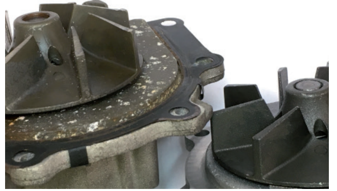
Resim 1: Çentik izli yer değiştirmiş pervane (solda), pervanenin doğru pozisyonu (sağda)
