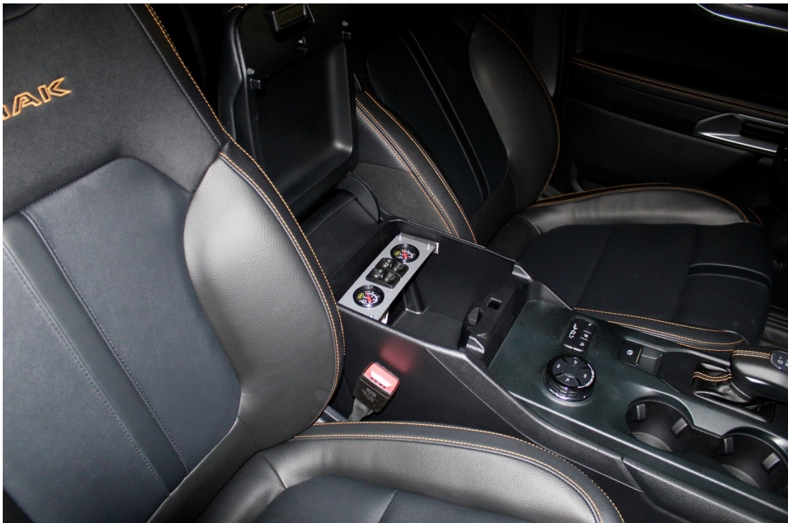
Einbau der fahrzeugspezifischen Armatur mit Manometer (Bedienteil) in der Mittelkonsole Installation of the vehicle-specific fitting with pressure gauge (operating unit) in the centre console
