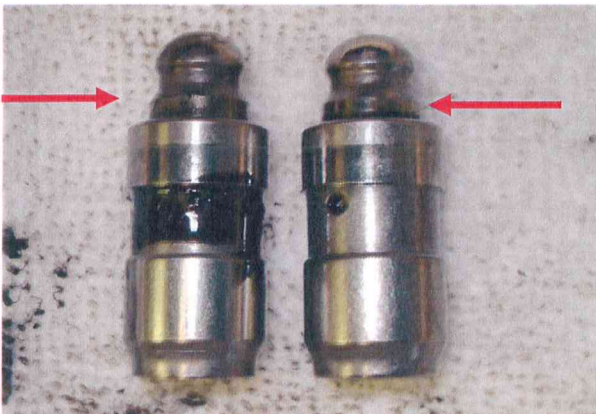
Bild 3: Hydrostößel li. maximal ausgefahren, Ventile dichten nicht - Stößel ersetzen
