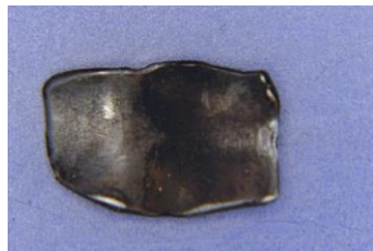
Beispiel für Bruchstücke aus einem Auspuffkrümmer
