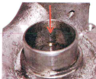
Ölnebeleintrag in das Verdichtergehäuse
