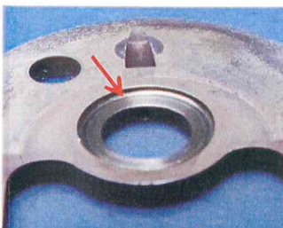
Durch Axialschub eingelaufenes Axiallager
