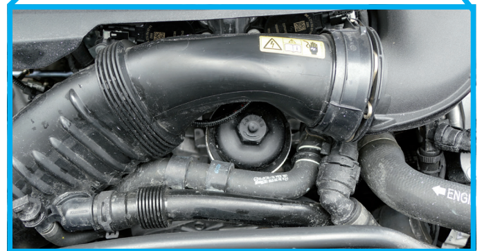
Rys. 3: Miejsce montażu filtra oleju w komorze silnika w Mercedesie C200, silnik M264
