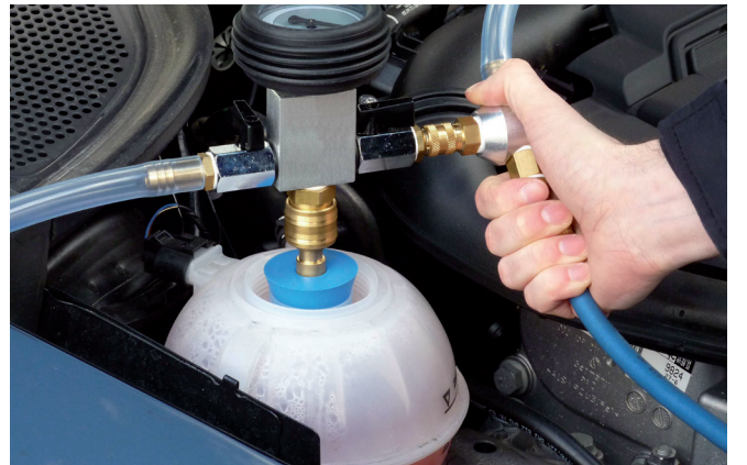
Resim 3: Venturi etkisi aracılığıyla sistemde bir vakum oluşur.
