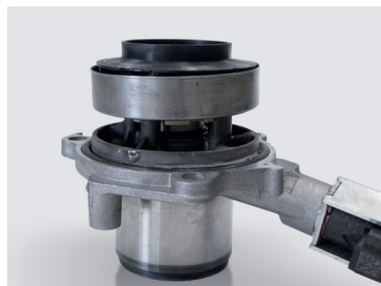
Zdjęcie 1: Regulowana pompa chłodziwa z przesłoną osadzoną na stałe (brak cyrkulacji)
