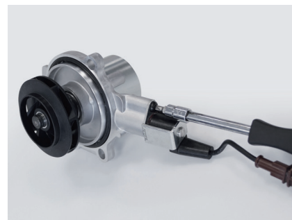
Zdjęcie 3: Nowa, nieregulowana pompa chłodziwa z zamontowanym aktuatorem
