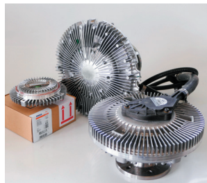
Abbildung 1: Je nach Bauart und Ansteuerung variiert die Transport- und Lagerposition. Maßgeblich ist die Beschriftung auf der Verpackung
