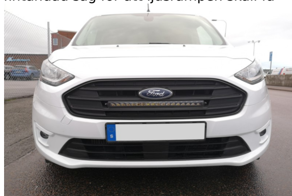
I grillens nedre del, i raden under Ford-märket behöver plats sågas ut med en fintandad såg för att ljusrampen skall få
