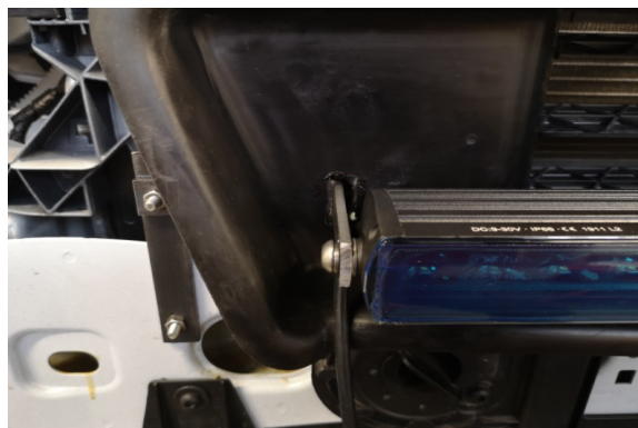
Fästena monteras och förs genom öppningarna som sågats upp, ljusrampen monteras.
