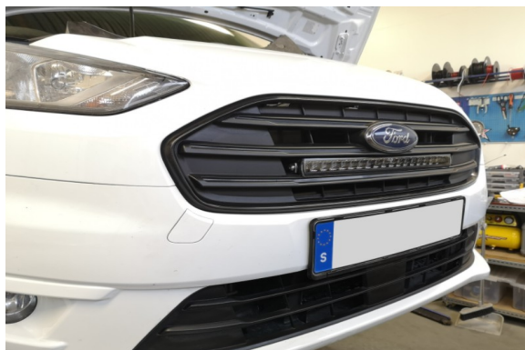
Återmontera stötfångaren, koppla in extraljuskablaget (se föregående sida).
