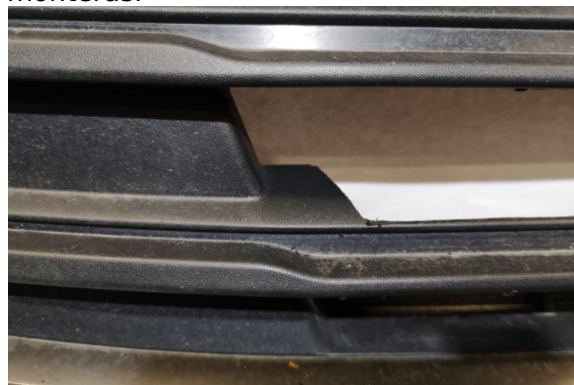
I grillens nedre del, i raden under Ford-märket behöver plats sågas ut med en fintandad såg för att ljusrampen skall få
