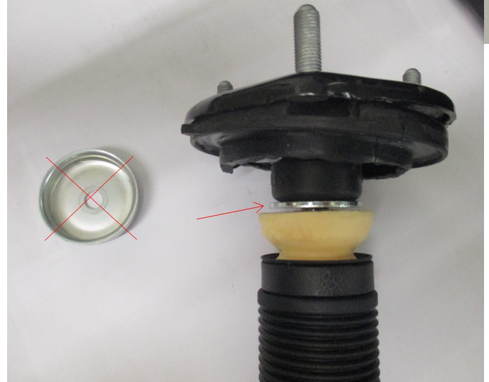
Abb. 2: OE Anlaufscheibe wird durch mitgelieferte ersetzt (Abb. ähnlich)
