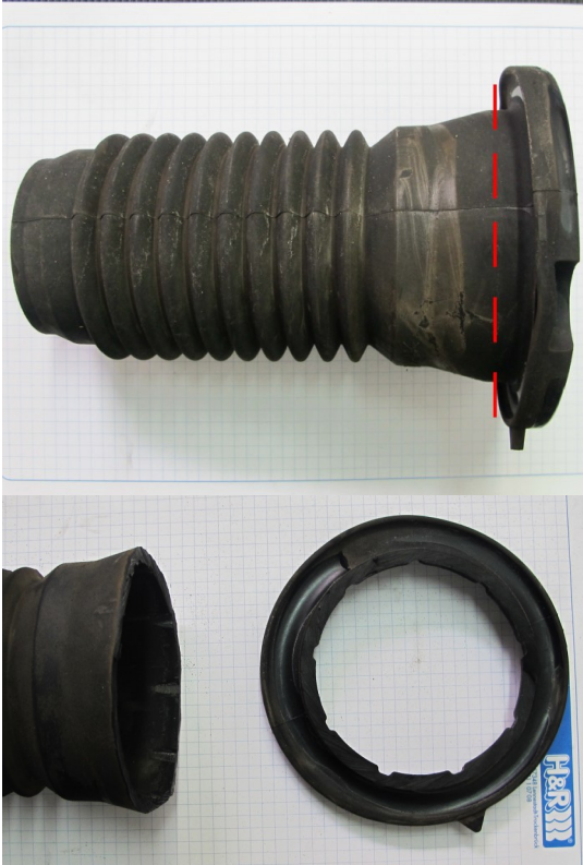
Abb. 1: Federunterlage VA kürzen (Abb. ähnlich)
