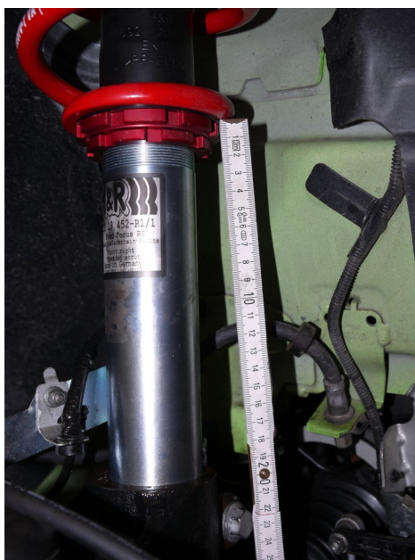
Abb. 4: Einstellmaß VA (Abb. ähnlich) Fig. 4: adjustment dimension FA (Fig. may vary)
