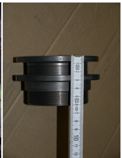
Abb. 5: Einstellmaß HA (Abb. ähnlich) Fig. 5: adjustment dimension RA (Fig. may vary)
