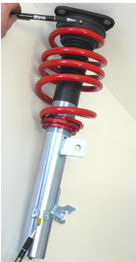
Abb. 3: Positionierung Dämpfer/Stützlager (Abb. ähnlich) Fig. 3: Positioning damper and support bearing (Fig. may vary)
