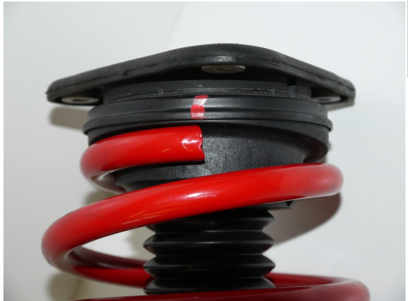
Abb. 2: Position Federende (Abb. ähnlich) Fig. 2: Position spring end (Fig. may vary)
