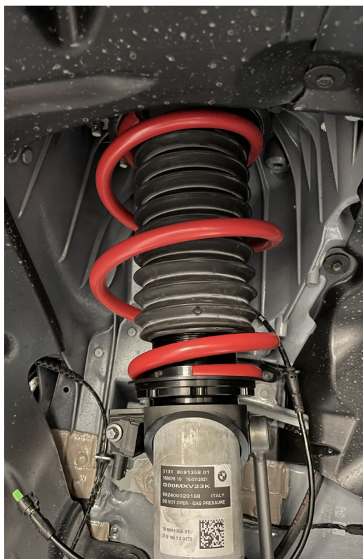
Abb. 8: Eingebauter Zustand: Das untere Federende zeigt zur Fahrzeugaußenseite
