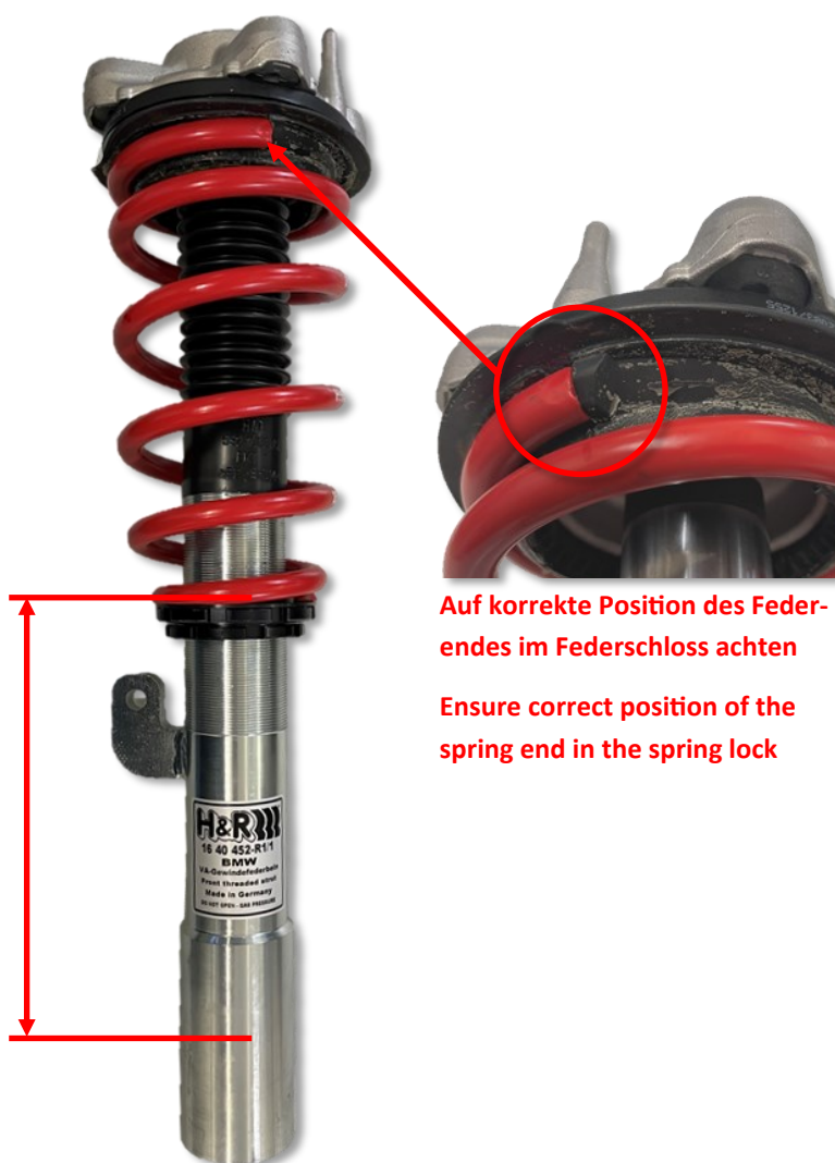
Abb. 2: Einstellmaß VA & Position Federende
