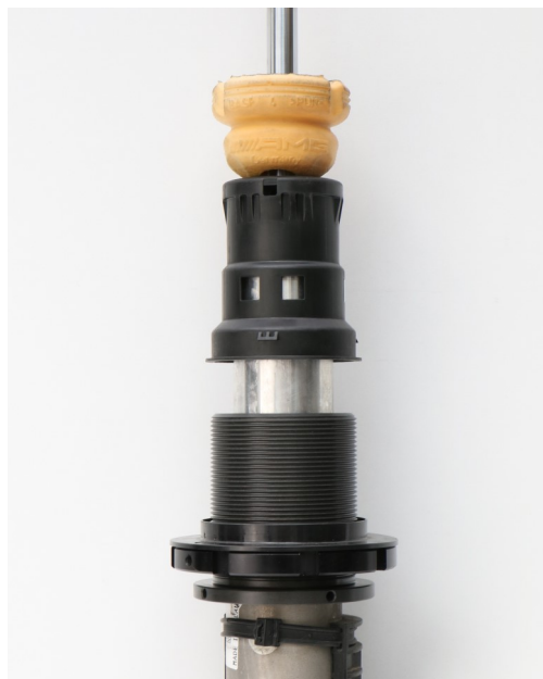
Abb. 2: Höhenverstellung und Abdeckkappe mont.
