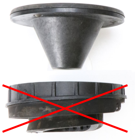
Abb. 4: Obere Federunterlage entfällt, Zentrierkegel wird wiederverwendet
