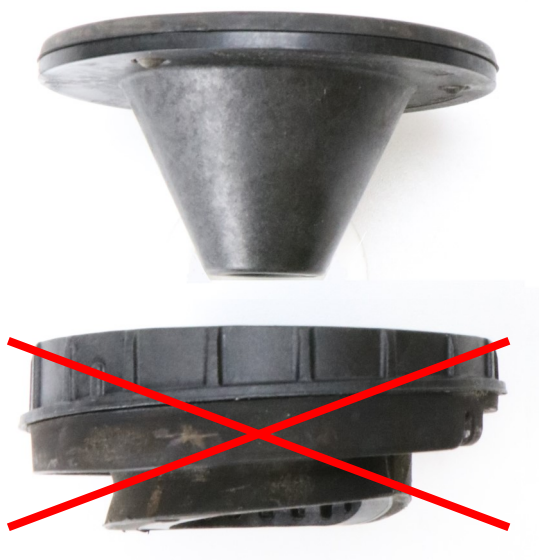
Abb. 4: Obere Federunterlage entfällt, Zentrierkegel wird wiederverwendet
