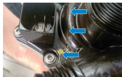
Problema provável da bomba de série: Quebra da caixa de material sintético.
