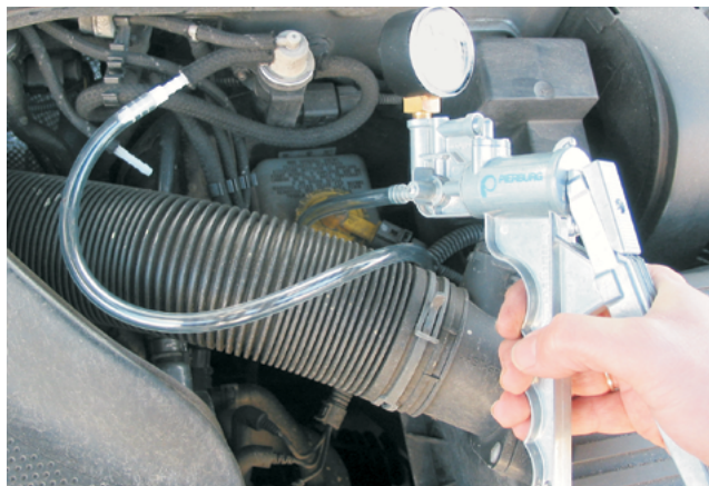
Controllo di un convertitore di pressione con la pompa di depressione manuale (VW Golf IV) (Pierburg Numero articolo 12 00001 11 900)
