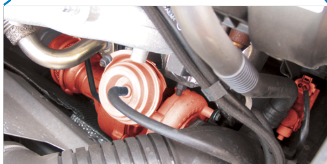
Convertitore di pressione e il compressore VTG (evidenziati in rosso) nell'Audi A4 TDI
