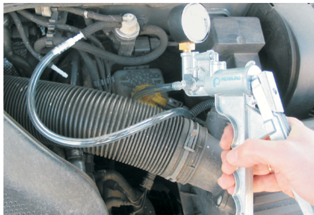
Kontrola przetworniki ciśnienia przy użyciu ręcznej pompy podciśnieniowej (VW Golf IV) (Pierburg Numer artykułu 12 00001 11 900)
