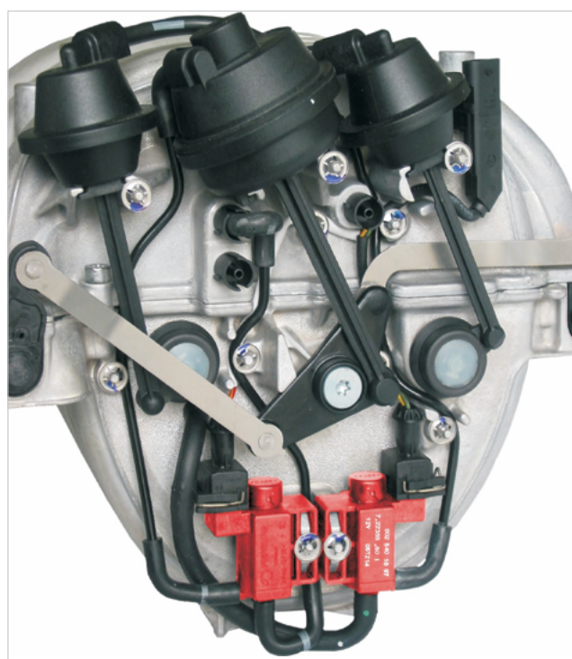
Exemplo de aplicação: coletor de admissão com válvulas eletropneumáticas (destacadas em vermelho) na Mercedes-Benz classe C
