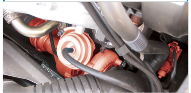
Audi A4 TDI'deki basınç konvertörü ve VTG şarj ünitesi (kırmızı işaretlenmiş)
