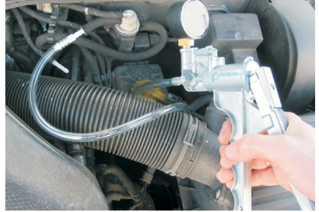
Bir VW Golf IV'te bir basınç konvertörünün el vakum pompası ile kontrol edilmesi (Pierburg ürün no. 12 00001 11 900)
