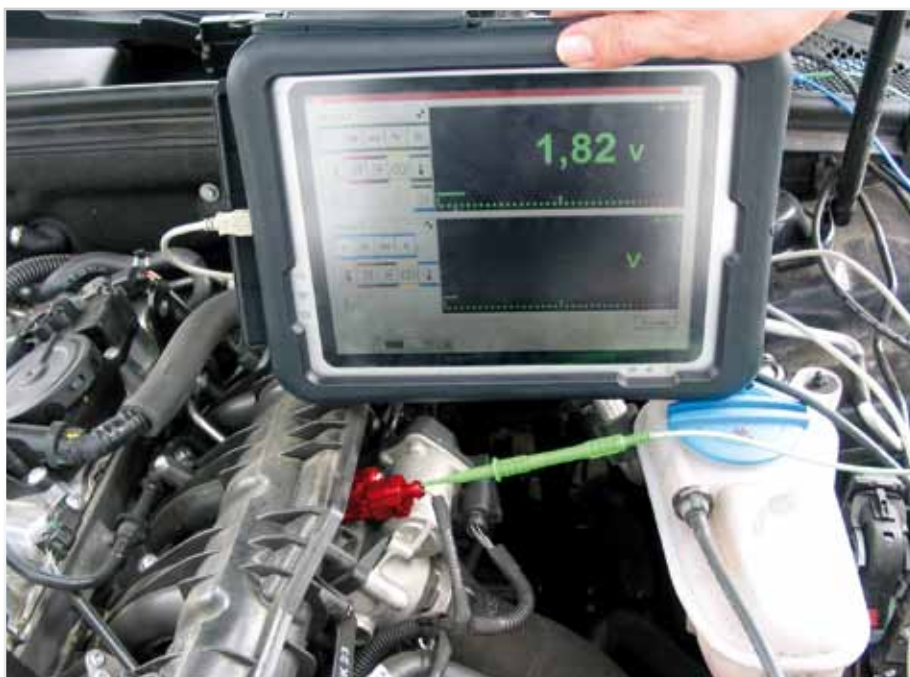
Misurazione della tensione di uscita sul sensore pressione tubo di aspirazione (evidenziato) nell'Audi A4 TFSI
