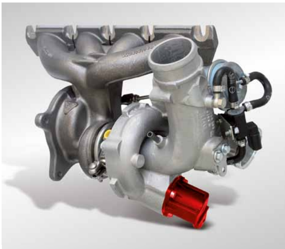
Supapa de descărcare (evidențiat) la turbina de supraalimentare a unui Audi A3 2.0 TFSI
