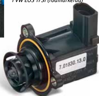
Återcirkulerande dumpventil i VW EOS TFSI (rödmarkerad)
