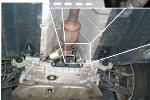
Återcirkulerande dumpventil i VW EOS TFSI (rödmarkerad)
