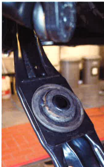
Abb. 2: Das Federgummi ersetzt das Federschloss
