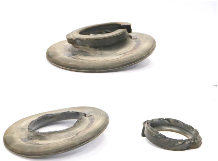
Abb. 7: Gummiunterlage bearbeiten HA Fig. 7: cut lower spring pad RA
