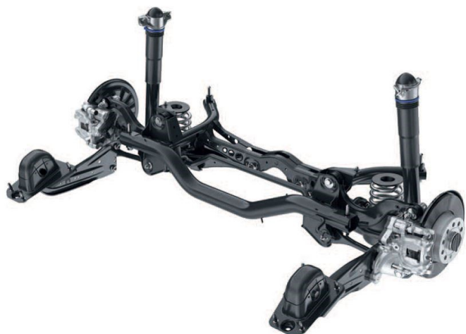
Abb. 1: Mehrlenker-Hinterachse Fig. 1: Multilink rear axle
