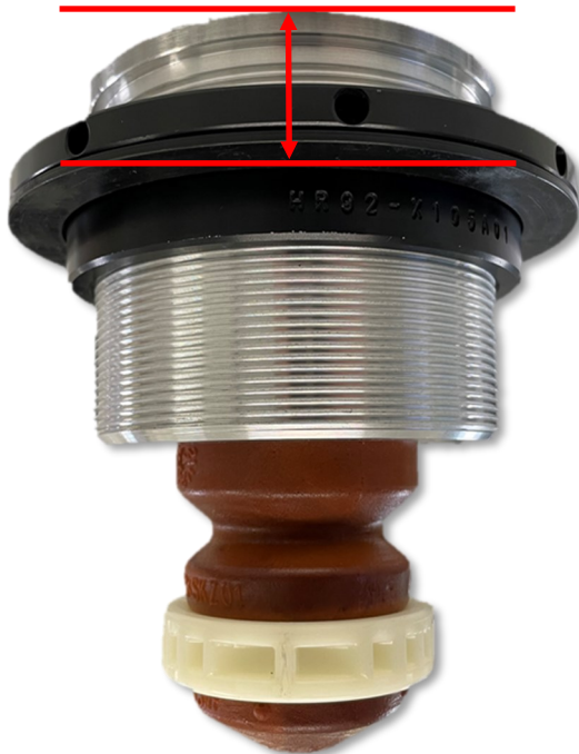
Abb. 5: HA Einstellmaß Fig. 5: RA adjustment dimension
