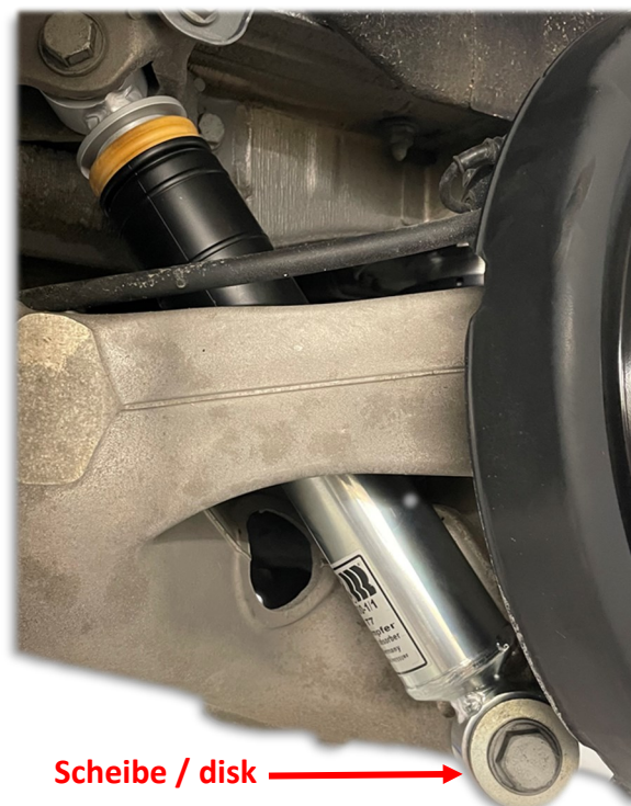
Abb. 7: HA Einbauzustand (Abbildung ähnlich) Fig. 7: FA installation condition (Picture may vary)
