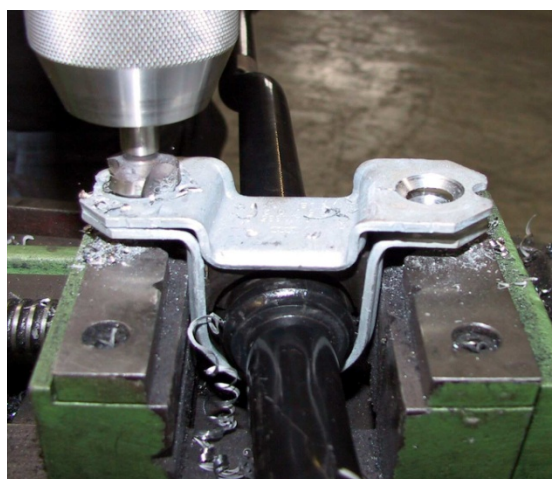
Abbildung 2: Aufbohren des Nietrandes Figure 2: Drilling of the nuts
