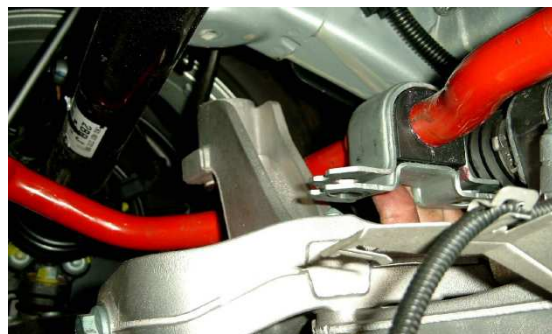
Abbildung 5: Einbau des H&R Stabilisators Figure 5: Mounting of the H&R swaybar
