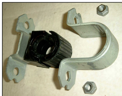
Abbildung 3: Ergebnis des Aufbohrens Figure 3: Result of the drilling
