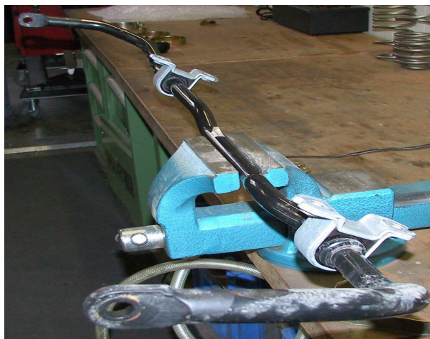
Abbildung 1: Serienstabilisator mit Schellen Figure 1: OEM sway bar with clamps
