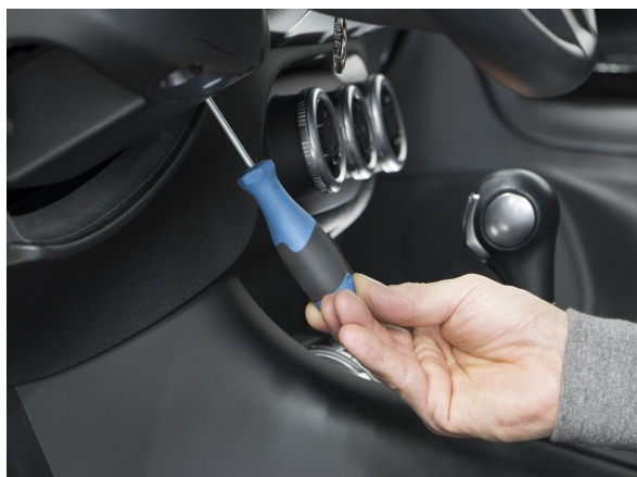
Używając śrubokręta można odblokować stacyjkę
