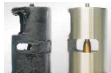
Abb. 2 Verrußtes AGR-Ventil und Neuzustand
