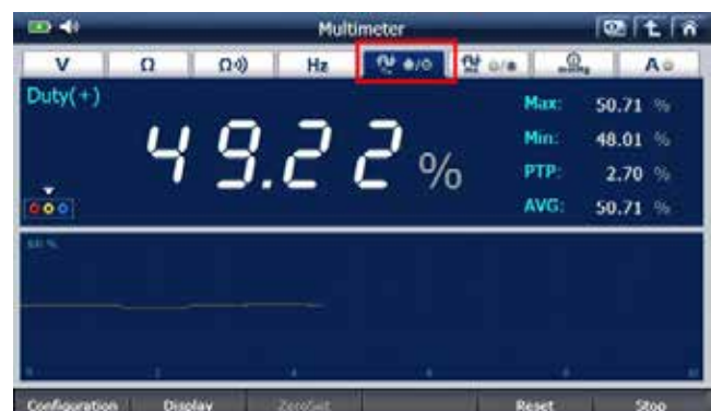
Multimeter – Messung der Tastverhältnis-Abgabe
